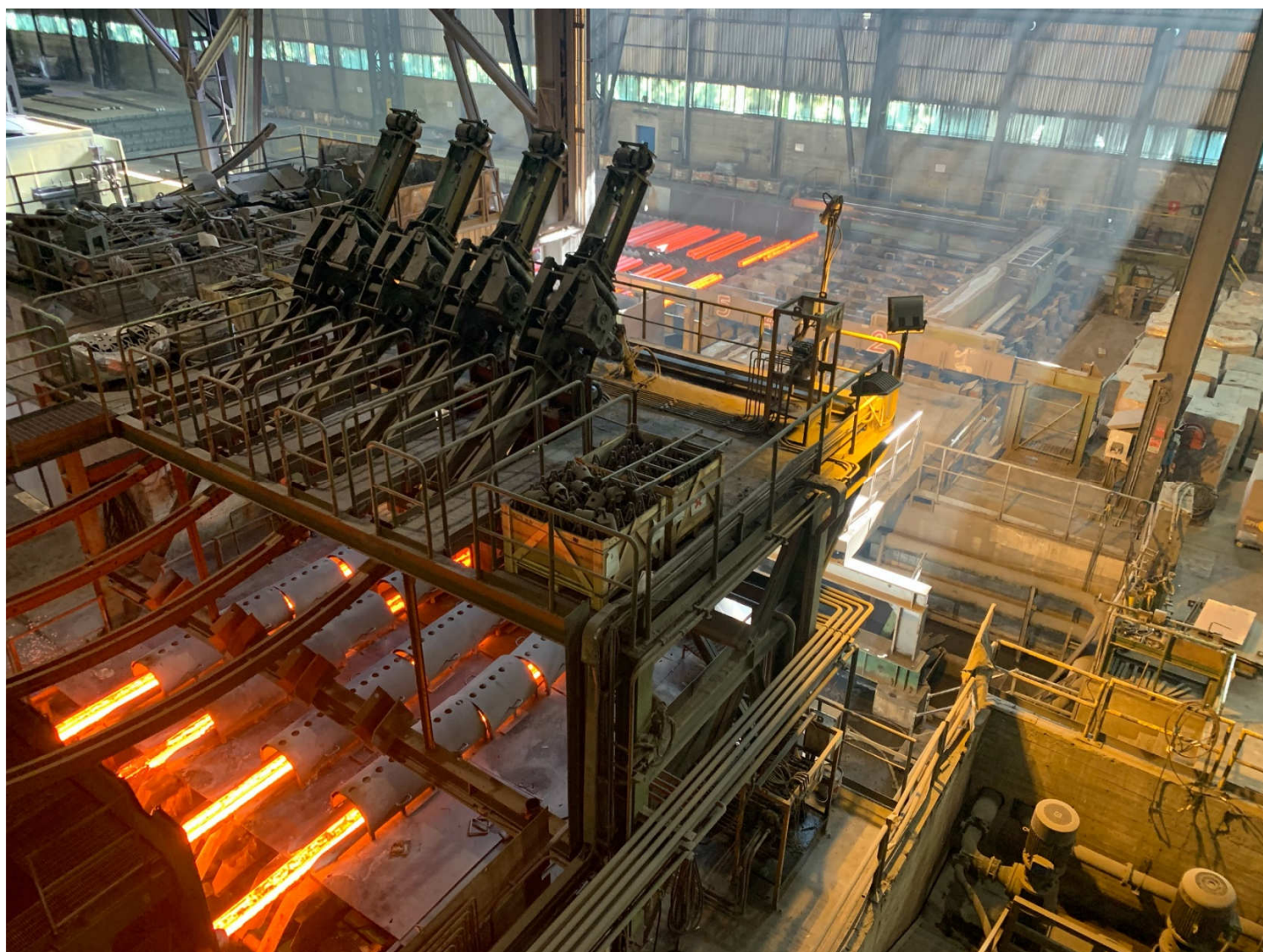
Figura 3.3.4 - Vista su colata continua del sito Acciaierie Venete di Borgo Valsugana, principale fornitore di billette per il sito di Buja
